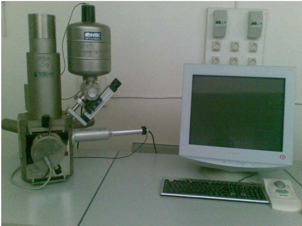
Figure II. 1: Microscope électronique à balayage (MEB).
