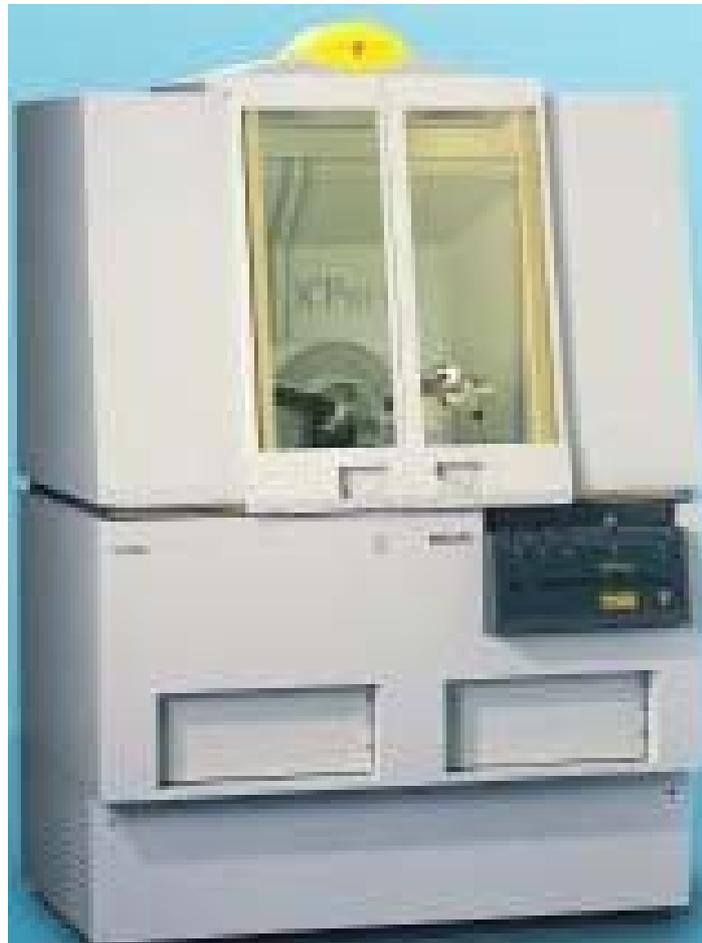
Figure II. 4 : Diffractomètre de marque 'X' pert PRO.
