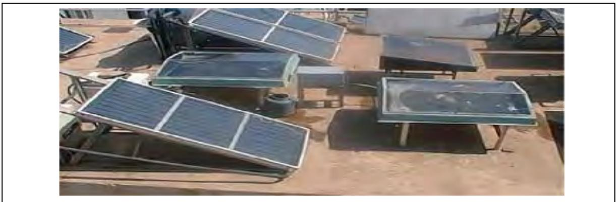
**Figure II.5 : Distillateur solaire couplé à un capteur**
