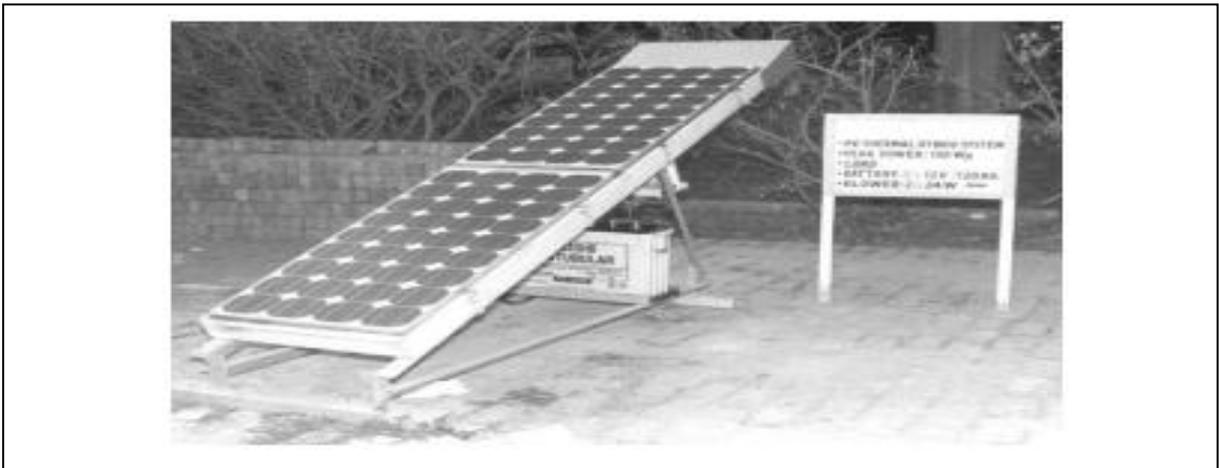
**Figure II.17 : Banc d'essai du capteur solaire PV/T hybride à air**
