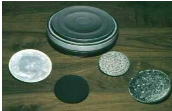
Figure 4 : Cible de pulvérisation cathodique pour applications électroniques.
