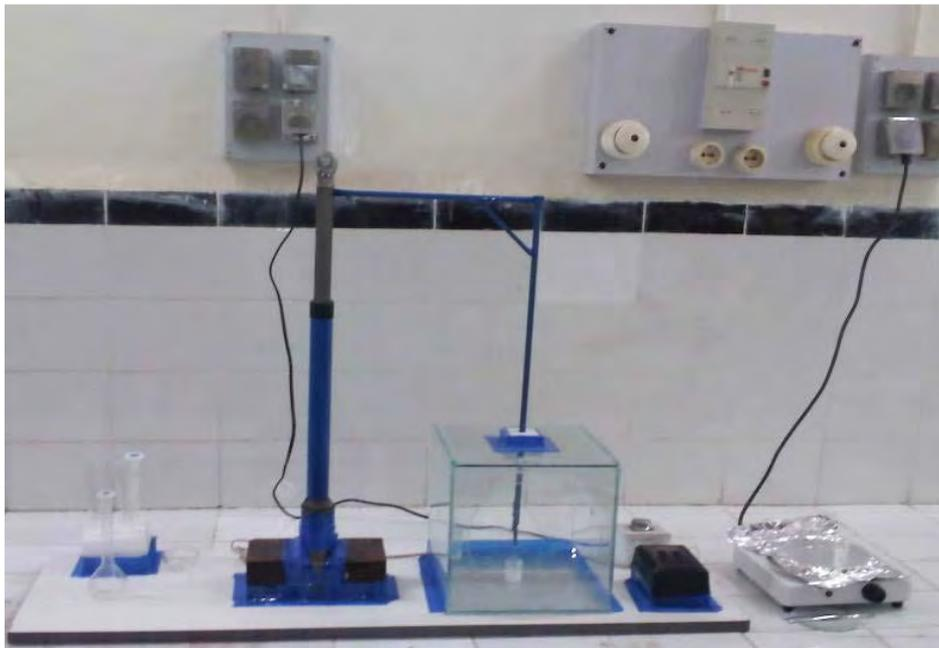
**Figure II.3.** Dispositif expérimental Sol-Gel de tirage des couches minces d'oxydes.
