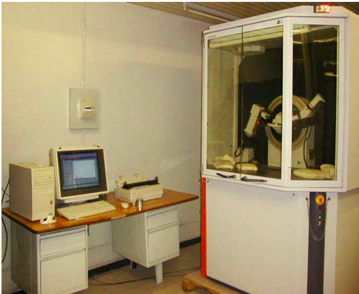
Figure II.1. Le diffractomètre de type Siemens D8 advance.
