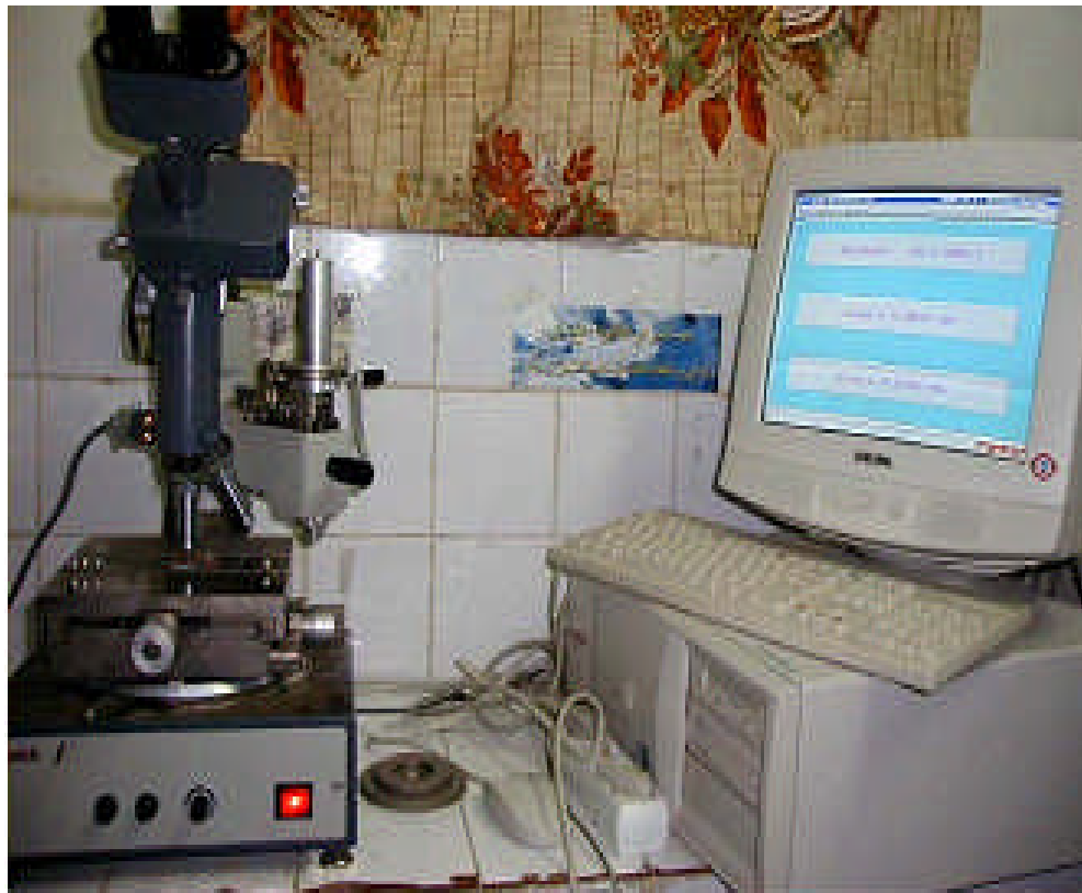
Figure II.2. Microduromètre utilisé de type ZWICK piloté par un microordinateur.
