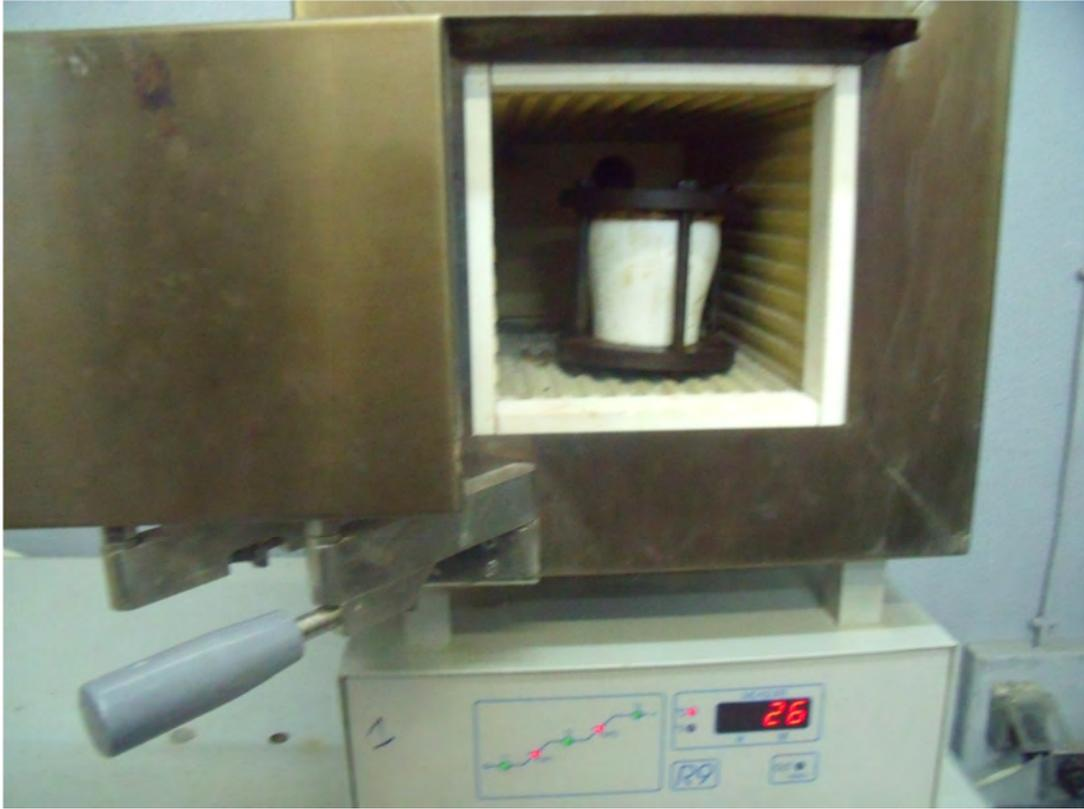
الشكل III-6 طريقة المعالجة الحرارية المائية في الفرن العادي
