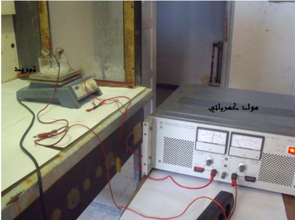
الشكل III-5 التركيب الموافق لطريقة الترسيب الكهروكيميائي
