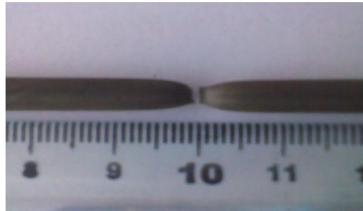
الشكل (III-2) : الإنكسار المطيلي كأس مخروط (cup-cone)
