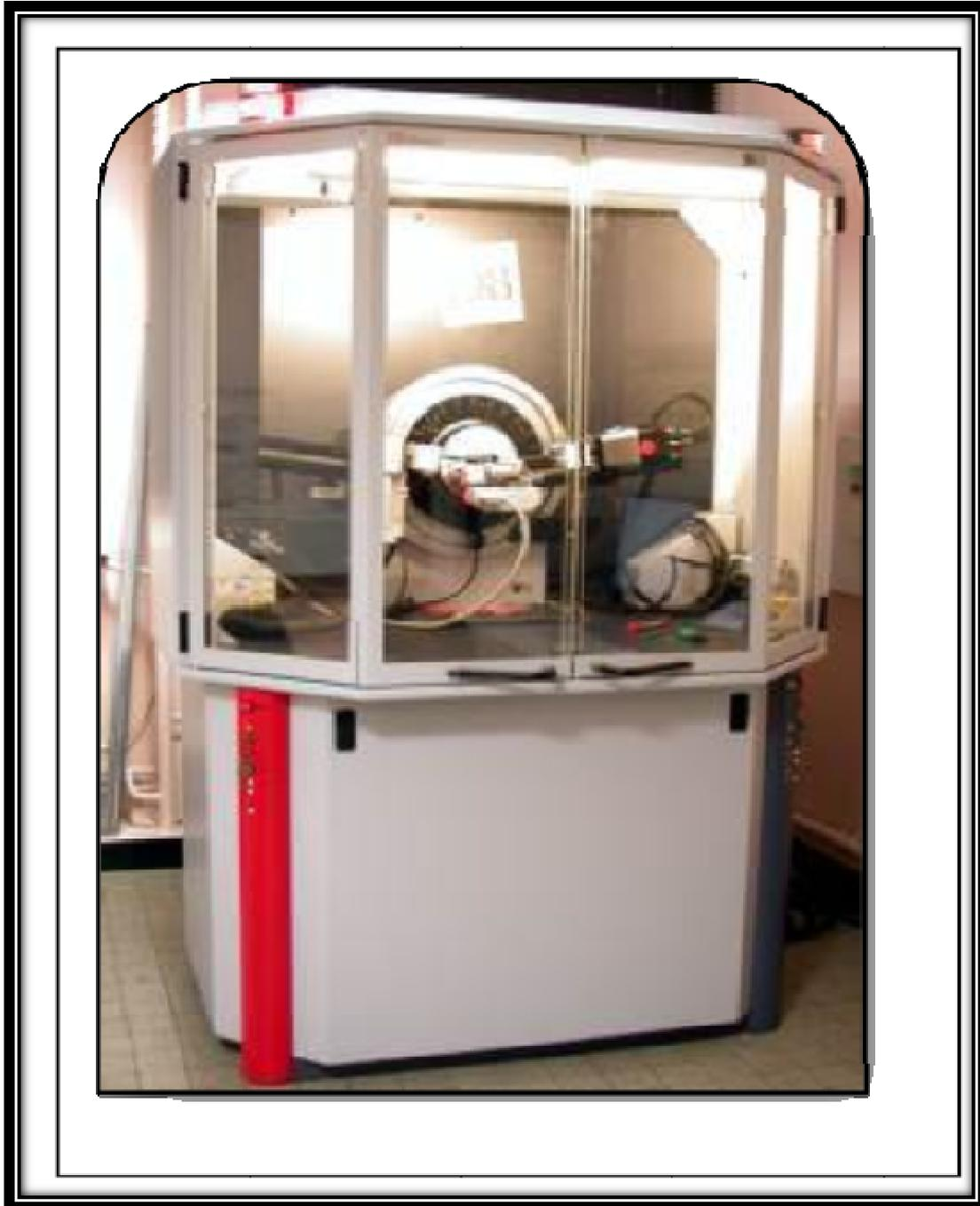
**Fig.III.1** Image d'un diffractomètre Bruker D8Advance
