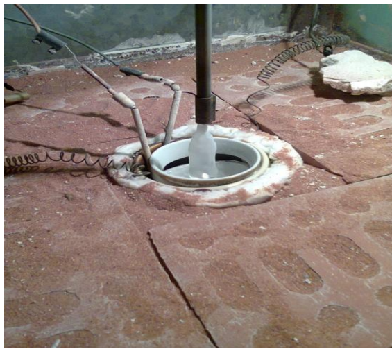
Fig.II.7 : Monocristal de KBr pendant la croissance
