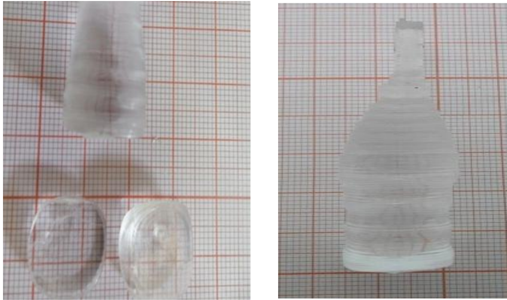
Figure II.9 : Clivage des monocristaux élaborés
