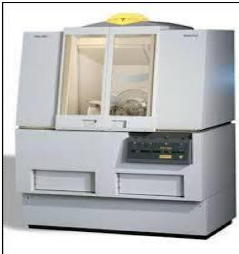
**Figure IV.1** Diffractomètre de type Philips X Pert Pro.
