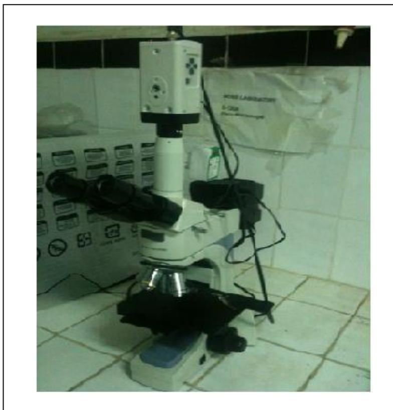
**Figure IV.6** Photographie du microscope optique G-120A.
