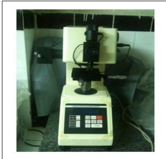
**Figure IV.5** Appareil de la microdureté de Vickers.
