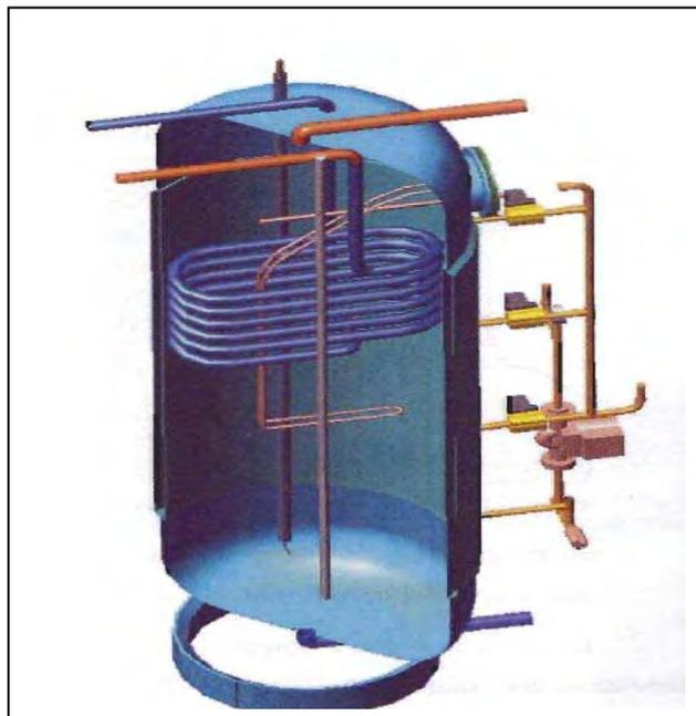
Figure II.25 : Ballon à échangeur manteau avec injection multi-niveaux.
