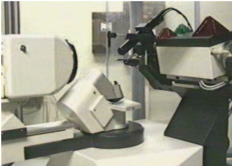
Figure I.10 : Diffractomètre NONIUS Kappa CCD
