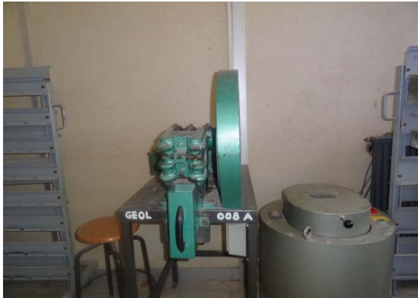
Figure 35 : Vue générale d'un Concasseur de type Concasseur Sait-Montory ; model T.O (MPI.31360).
