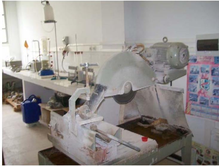
Figure 41 : Scie de découpe les sucres de type controls .
