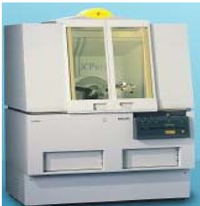
Figure 43 : Le diffractomètre utilisé de type X'PERT PRO PAN .
