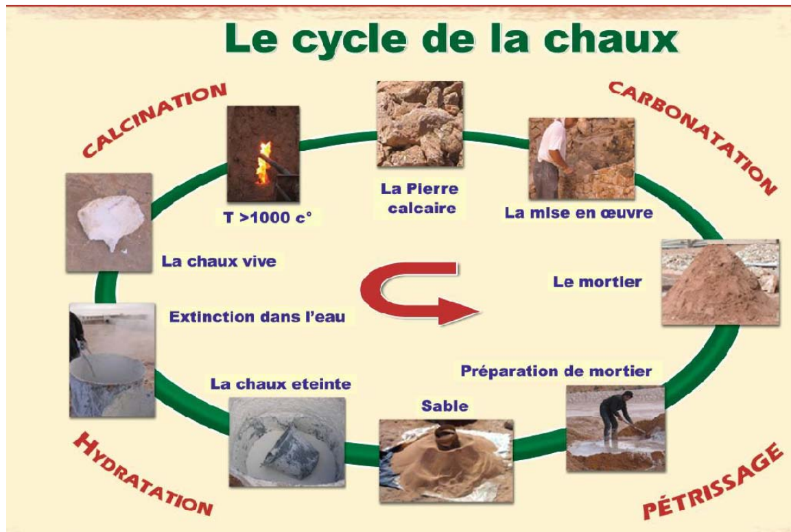
Figure 30 : Le cycle de la chaux [37].
