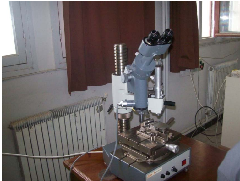
Figure 47 : La machine du la microdureté ZWICK .
