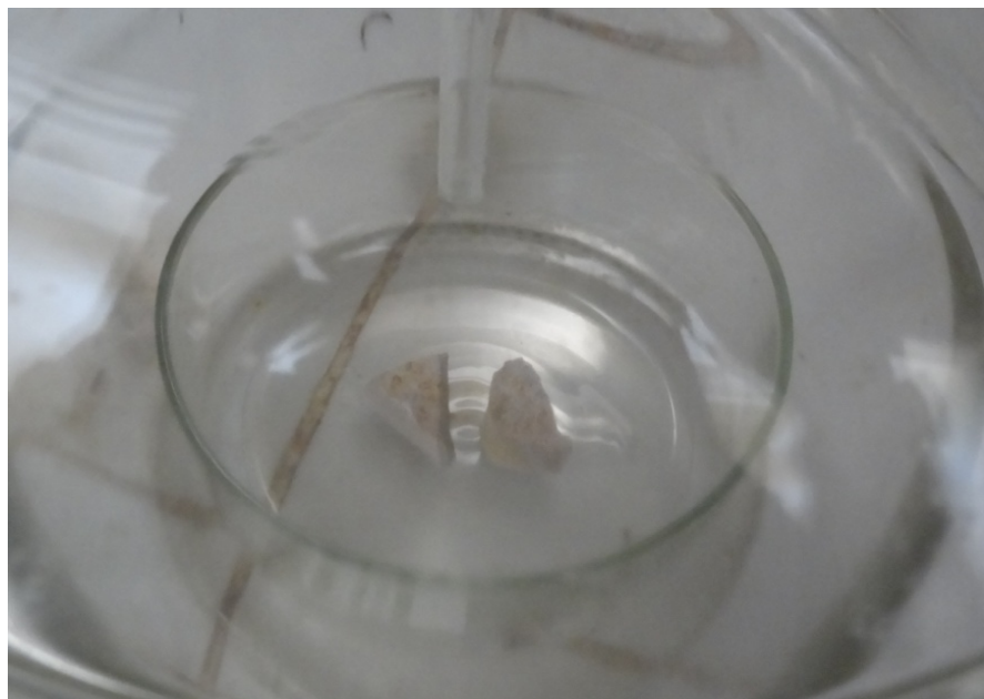
Figure 48 : Montage de mesure de la porosité à l'eau.
