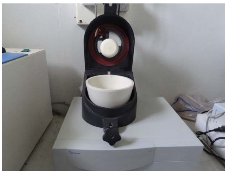
Figure 37 : Broyeur à mortier de Type RM 100 et de marque RETSCH.
