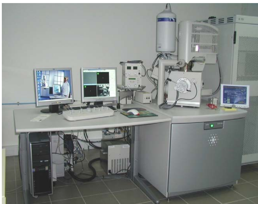
Figure 45 : Le Microscope électronique à balayage utilisé de type environnemental (ESEM).
