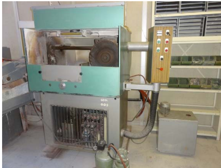
Figure 40 : Scie servant à découper les lames model R. Riédoz Besançon .
