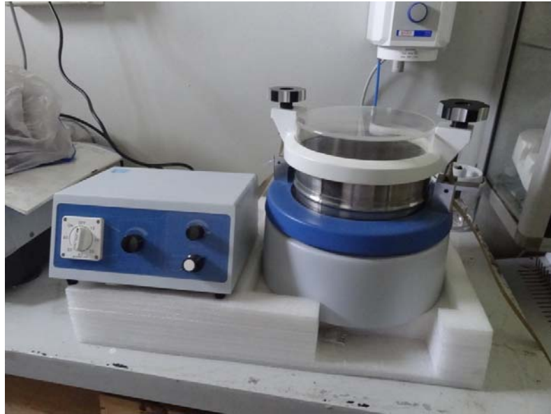
Figure 38 : Tamiseur électrique de marque WQS (vibrating screen).
