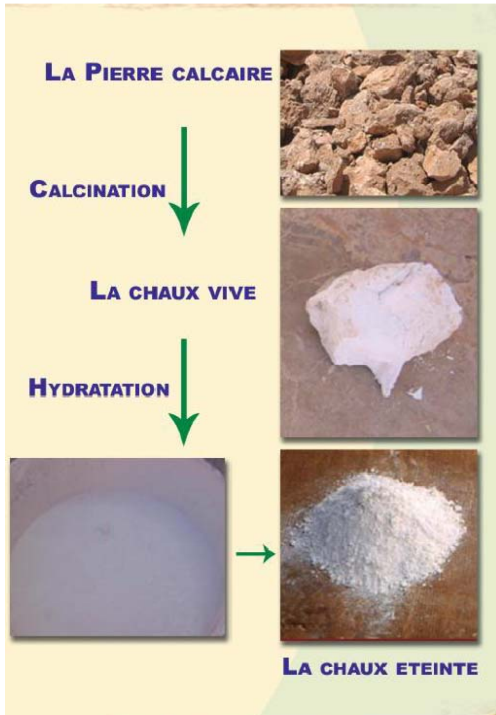
Figure 29 : Fabrication de la chaux [37].
