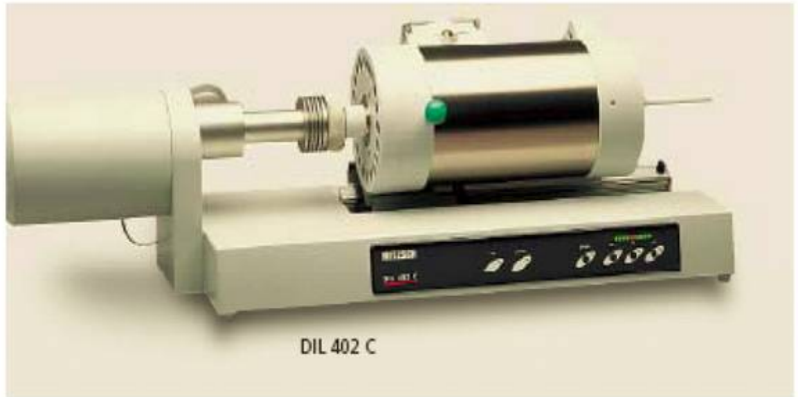
Figure IV.4 Dilatomètre de type DIL 420C NETT ZSCH4.
