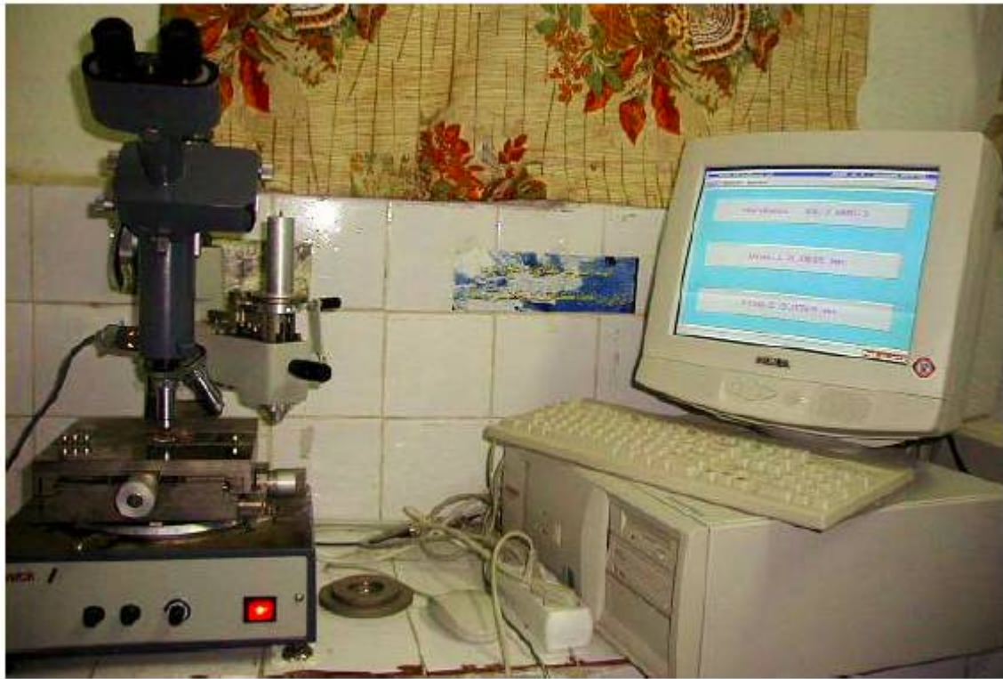
Figure IV.5 Microduromètre de type Zwick.
