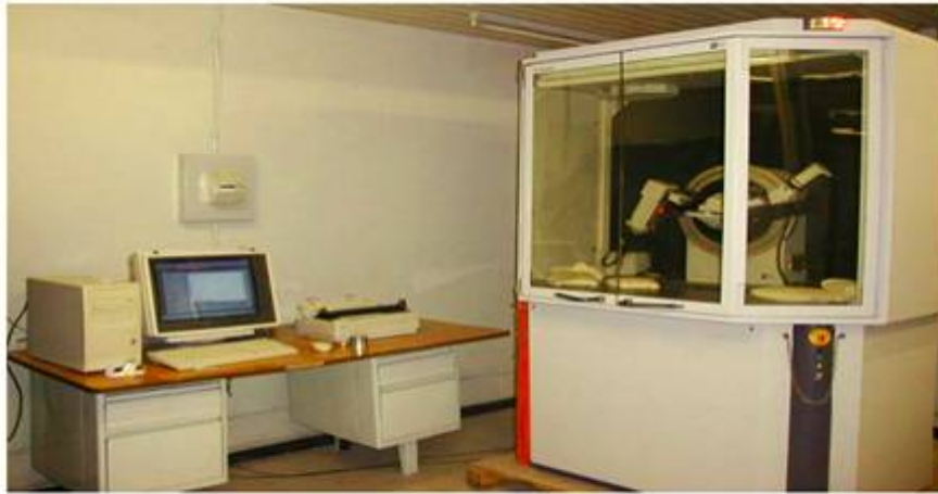
Figure IV.2 Diffractomètre de type Simens D8 ADVANCE.
