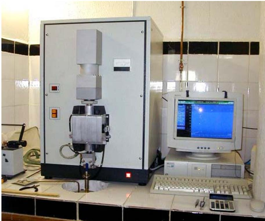
*Fig. III. 3 : Dilatomètre de trempe ADAMEL L HOMARGY de type DT 1000.*
