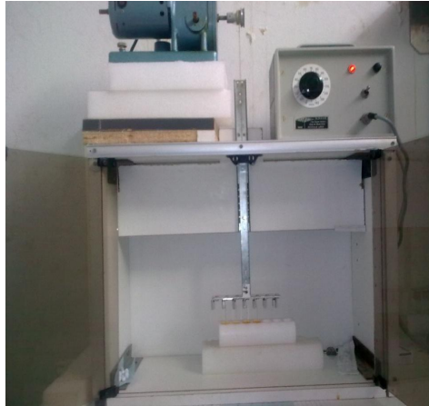
Figure III.3 :Dispositif de dépôt des couches minces par dip-coating (conception et mise au point aulaboratoire).
