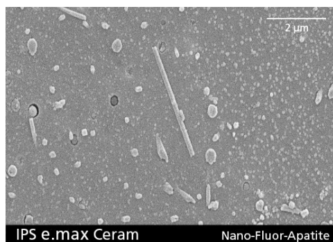
Figure 14. Microstructure des IPS e.max Ceram (image SEM): cristaux de fluorapatite dans différentes tailles [106].
