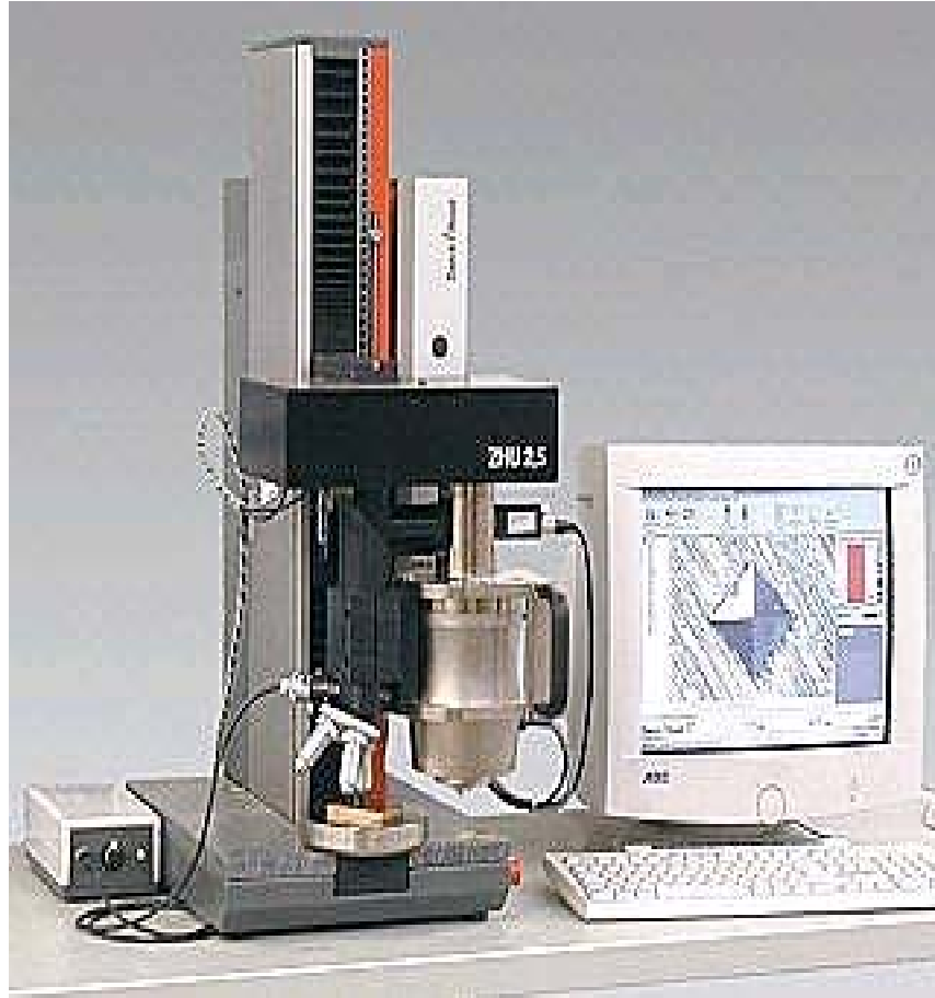
Figure 20. La machine du la microdureté ZWICK (ZHU 2,5).
