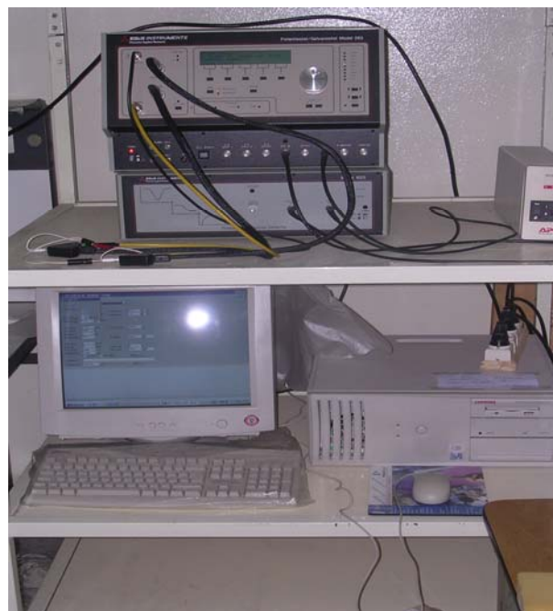
Figure 25. Potentiostat connecté à l'ordinateur.
