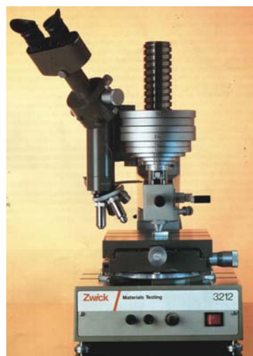
Figure 18. Essai de dureté Vicker. Figure 19. Le microduromètre utilisé de type ZW.
