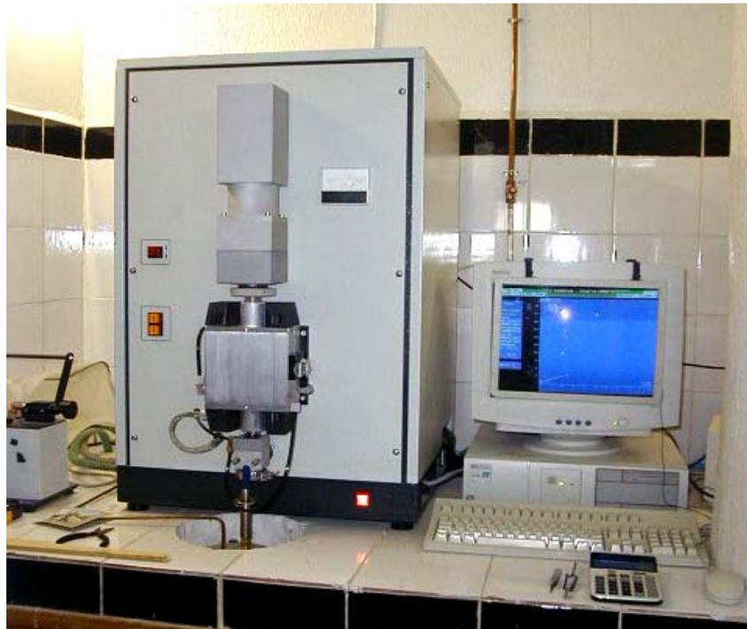
**Fig. 18** : Dilatomètre de trempe ADAMEL LHOMARGY de type DT 1000.
