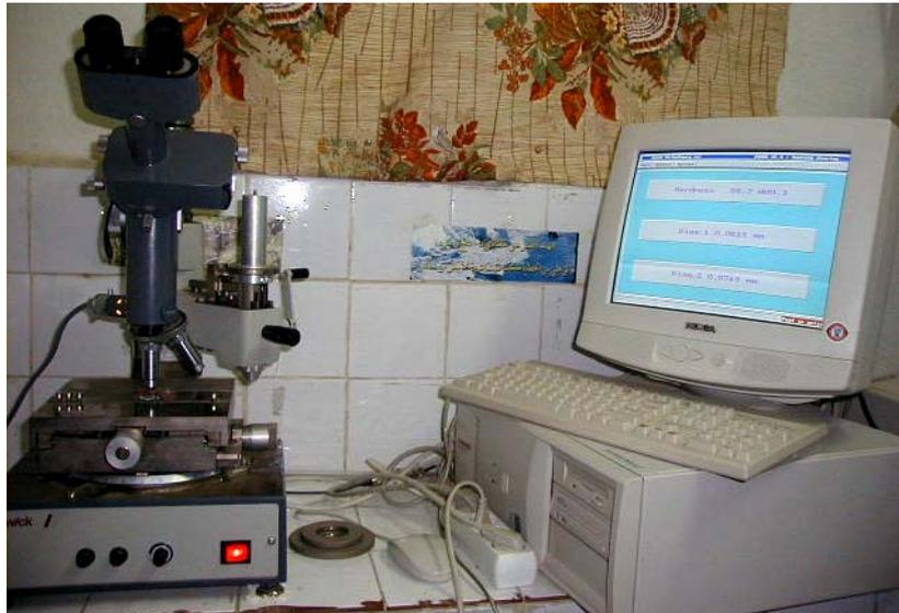
**Fig. 21 :** Microduromètre semi automatique Zwick de type B3212002
