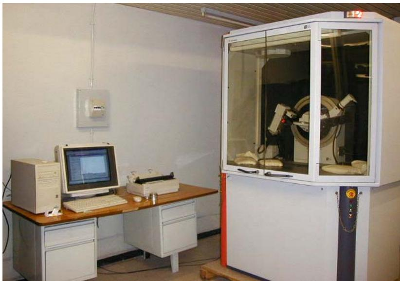
**Fig. 22:** Diffractomètre Bruker Siemens D8
