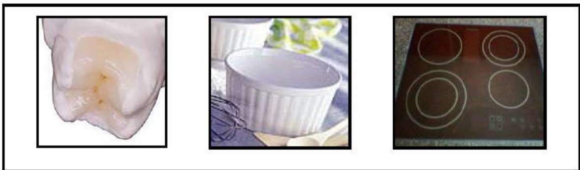
Figure 5 : Illustration des applications des vitrocéramiques. (a) Prothèse dentaire, (b) moule permettant une cuisson au four, (c) plaques de cuisson [58].
