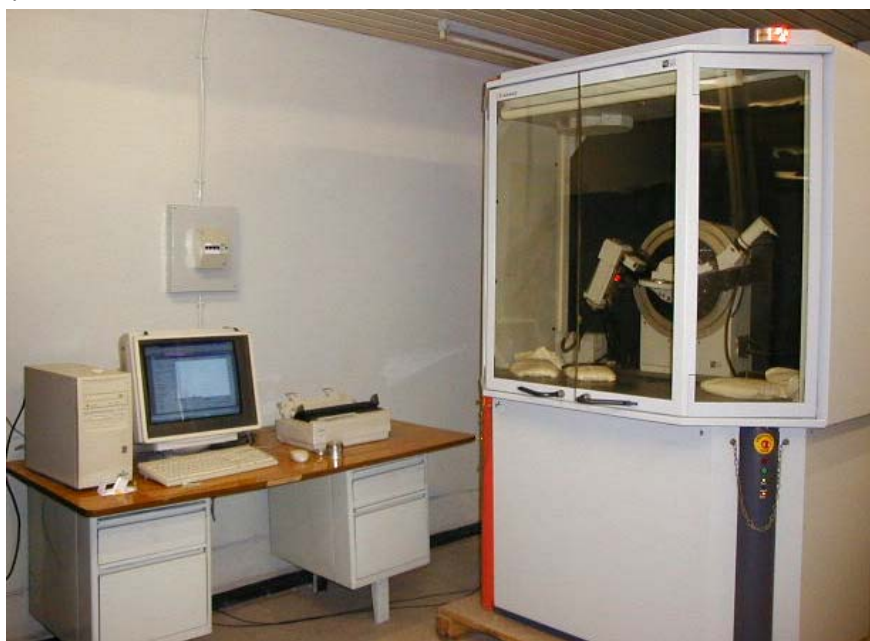
Figure III -5: Le diffractomètre utilisé de type Siemens D8 Advance relié à un microordinateur.
