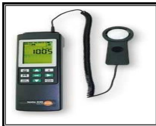
*Figure II.8 : Photomètre à base de CdS.*
