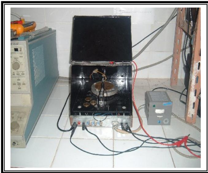
Figure III.12.a : Système des deux points, réalisé au LCMI (Université de Constantine).
