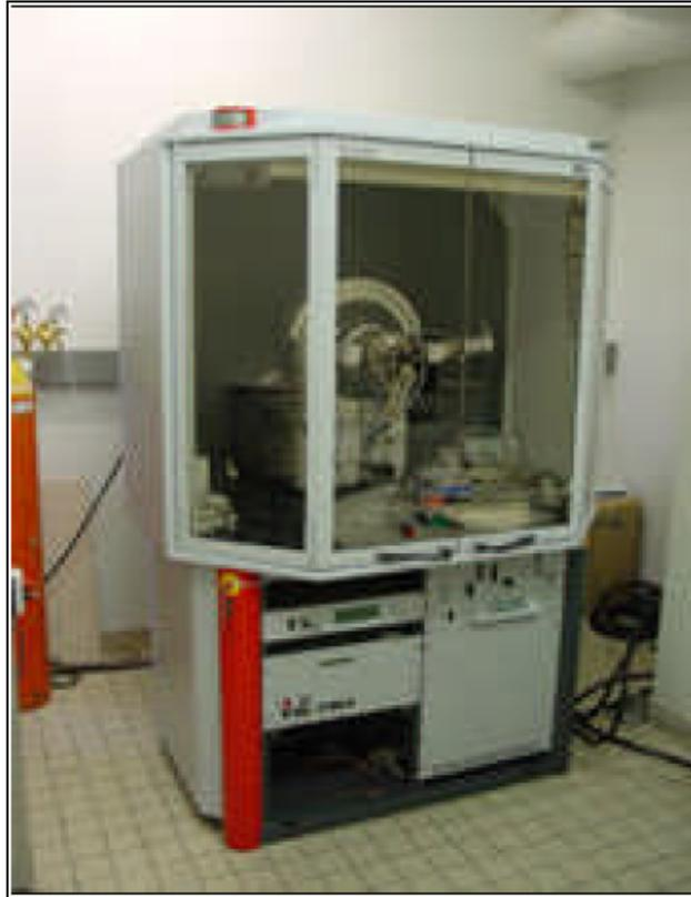
Figure II.5. Photo de diffractomètre de type (BRUKER - AXS type D8).
