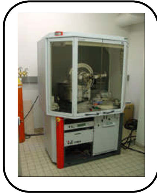
Figure. II.8. diffractomètre de marque BRUKER - AXS type D8.
