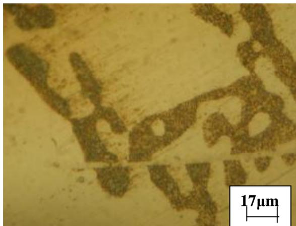
**Fig. 36.** Microstructures de la phase  $\theta$  ( $\text{Al}_2\text{Cu}$ ) dans l'alliage Al-46,56 % mass. Cu homogénéisé 4 h à 400 °C avec différents grossissements: X100(a), X500(b), X1000(c).
