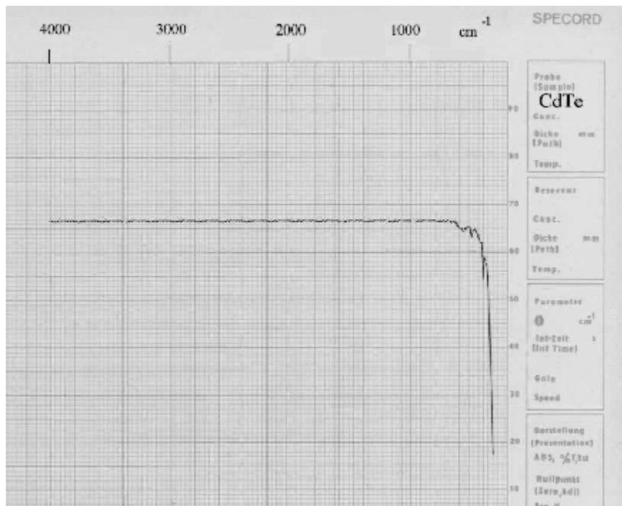
Fig. IV.13 Spectre infrarouge de CdTe massif [2].
