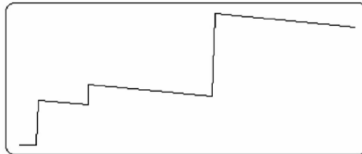
FIG. 3.7 – Signal délivré par un préamplificateur
