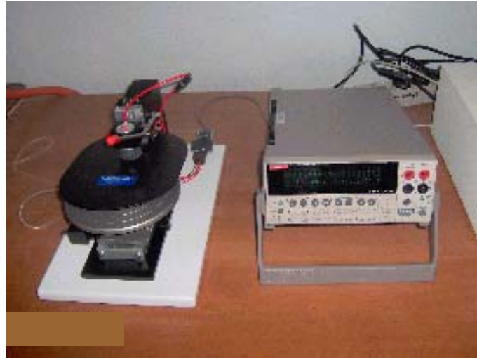
Fig. II.10 - Dispositif de mesure de la résistivité « quatre points »
