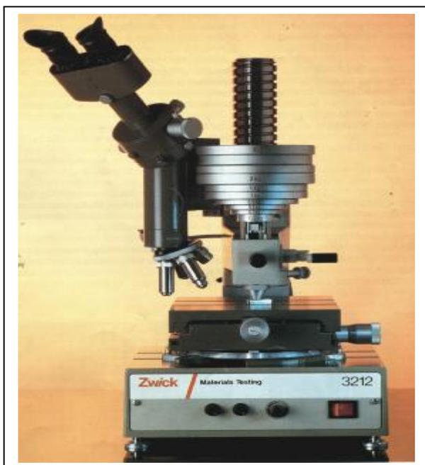
*Fig. 4. Le microduromètre utilisé de Type ZWICK*
