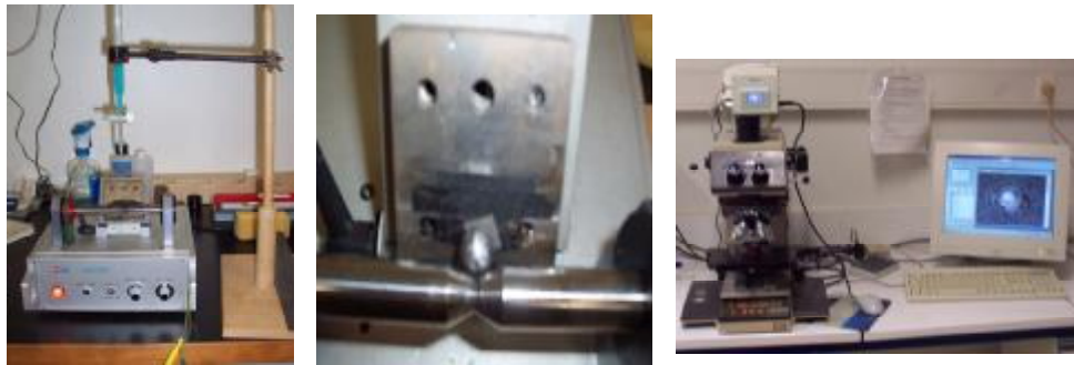
Fig. 15 : a) Montage du calotest, b) Bille en contact avec l'échantillon c) Obtention de l'empreinte par microscope optique.
