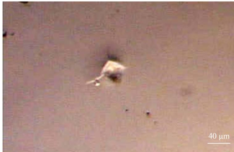
Fig.IV.3: Micrographie optique de l'échantillon a-Si (1000 Å) / silicium monocristallin indenté par une charge de 20 gf pour 50 indentations.
