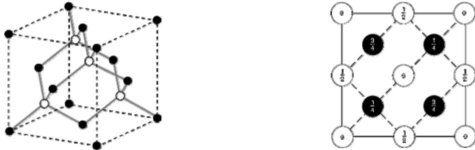
**Fig.I.10.** Réseau cristallin dans la structure zinc-blende.
