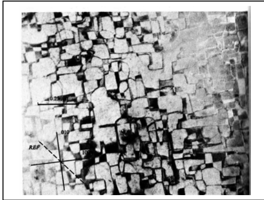
Fig. 31: Structure des domaines d'antiphases dans Cu_3Au partiellement ordonnée après un vieillissement de 75 h à 380^\circ C et la taille des domaines est presque de 750^\circ A , avec une forte anisotropie de l'énergie des PAPHs [15]
