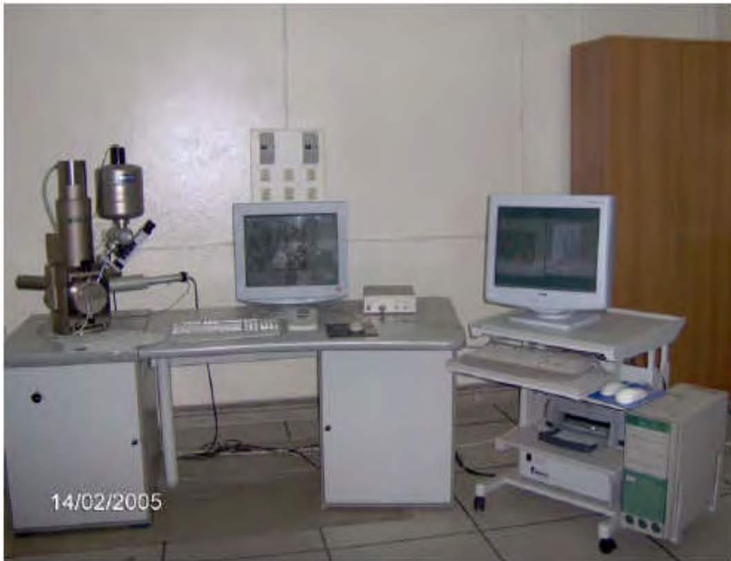
Figure III.17 : Système EBSD au Laboratoire Microstructure et Défauts. A gauche le MEB ; au centre un PC pour l'imagerie MEB et l'analyse d'images ; à droite un PC pour les analyses EBSD et EDX.
