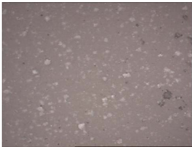
Fig. 3.1: Images obtenues au microscope optique en réflexion des films minces (le grossissement est de 100; conditions de dépôt: 3000tr/min, 20s)
