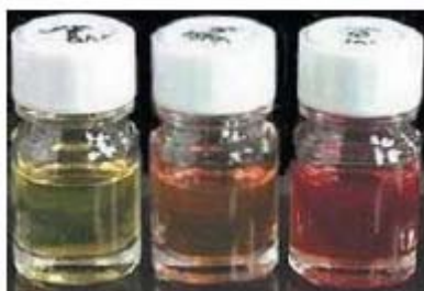
Fig. 1.16: Absorption à température ambiante de dispersions colloïdales de nanocristaux de CdSe.
