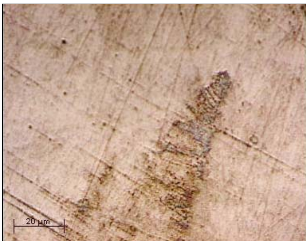
Figure (V.19): Résultats des essais de polarisation cyclique dans la solution 0.5% NaCl : aspect visuel de l'état de surface dans la solution H 2 SO 4 0.5M.
