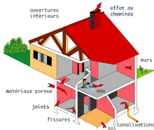
Figure 1-5 : Schéma de pénétration du radon dans l'habitat.
