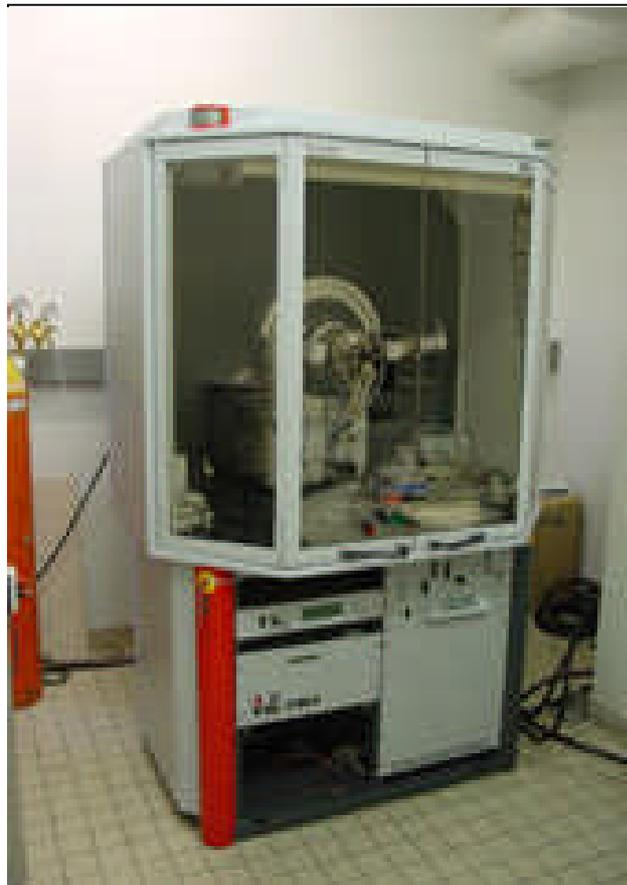
*Figure III.3 : Diffractomètre de type (BRUKER - AXS type D8).*
