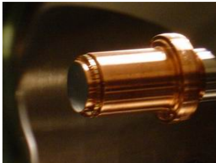
Figure 16. Image de la photocathode avec le dépôt en tellure de césium Le diamètre de la surface du dépôt est de 2 cm.
