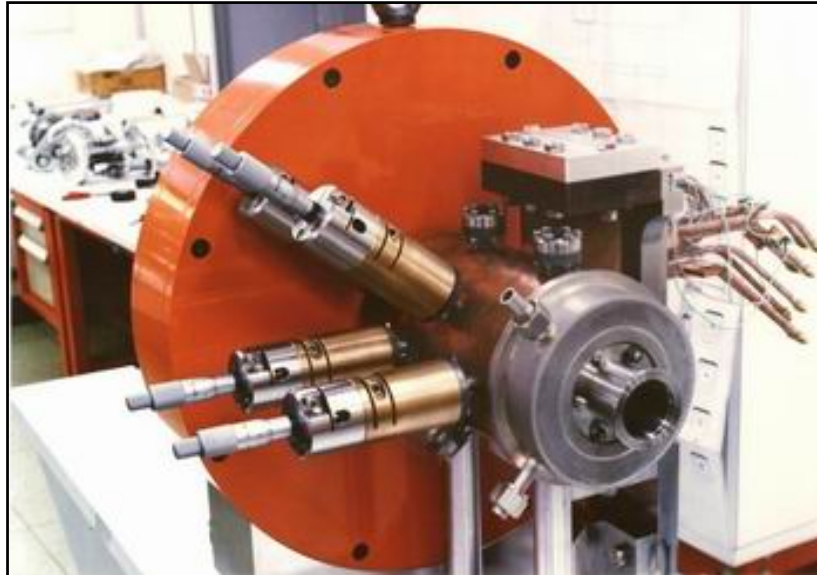
Figure 17. Solénoïde qui assure la focalisation du faisceau d'électrons vers la section RF accélératrice.
