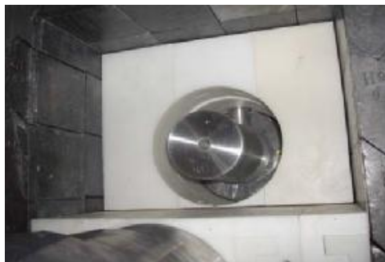
Figure 5-8 : Vue intérieure du blindage sans plomb archéologique
