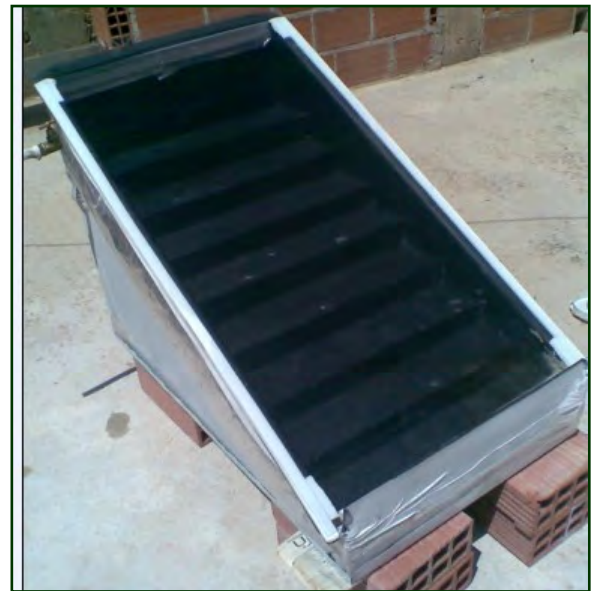
Figure III.4 Schéma finale du distillateur à cascade
