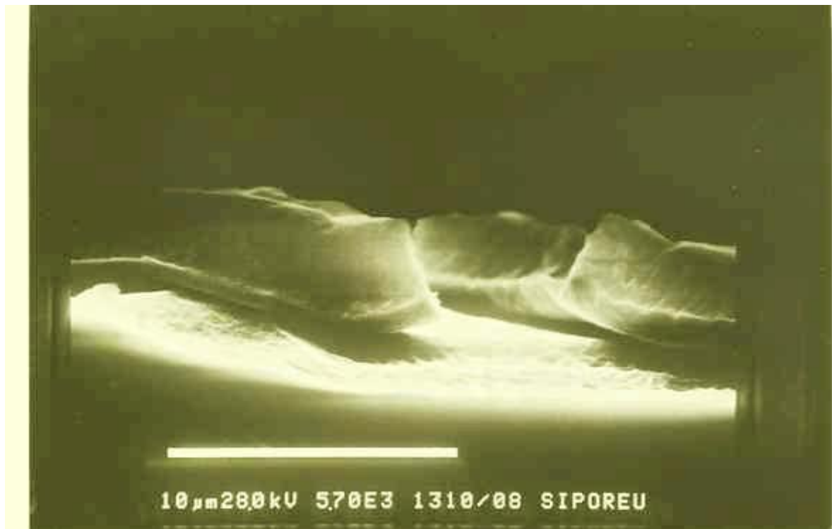
Figure III.8.a : Image MEB d'une surface de silicium poreux (Ech.5), vue transversal montre d'épaisseur de la couche poreuse.
