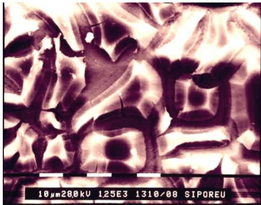
Figure III.8.c : Image MEB d'une surface de silicium poreux (Ech.5), vue plane montre la taille des voies et branches de la zone poreuse.
