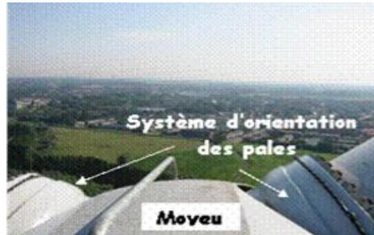
Figure (1-16): Système d'orientation des pales [3].
