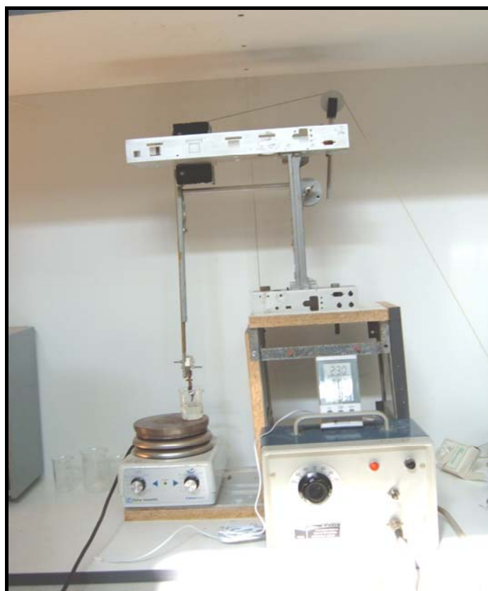
Figure III.3. Dispositif de dépôt des couches minces par dip-coating (conception et mise au point au laboratoire).
