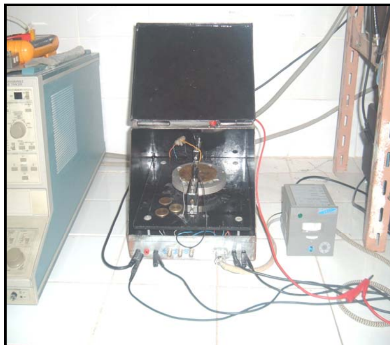
Figure III.10. Système des deux pointes, réalisé au LCMI (Université de Constantine).
