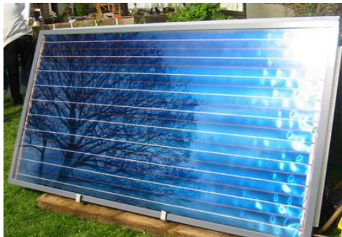
Figure III.1- Capteur solaire thermique.
