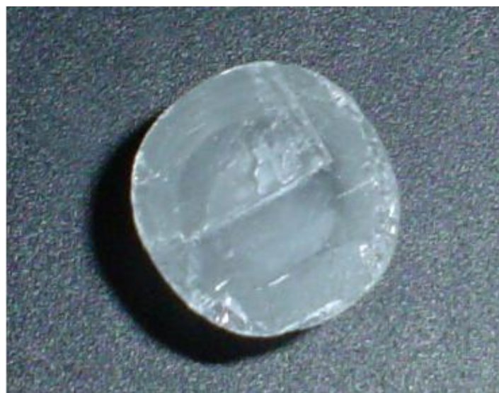
Fig. II-9-b : Photo d'une pastille de KBr dopé par les cristallites de GaAs
