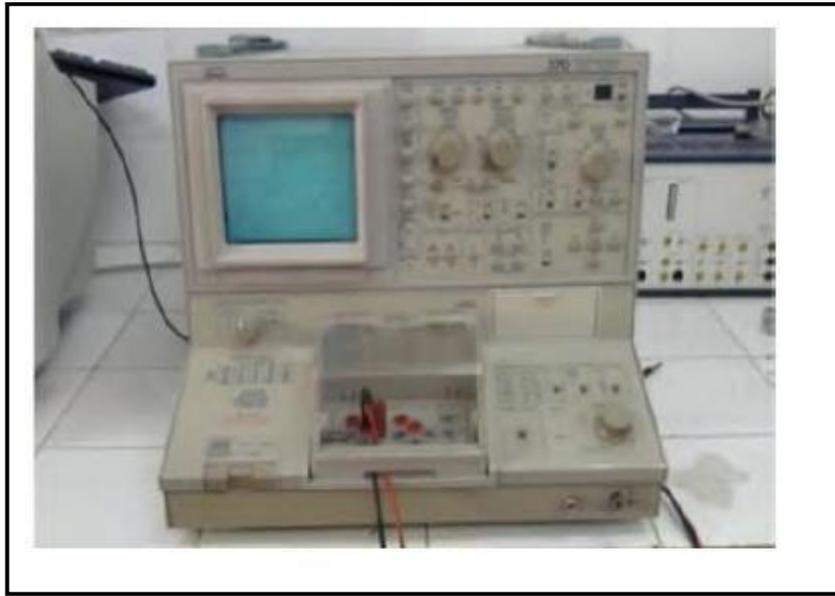
**Figure II.20** : Traceur de courbe V-I des structures utilisé dans le présent travail.
