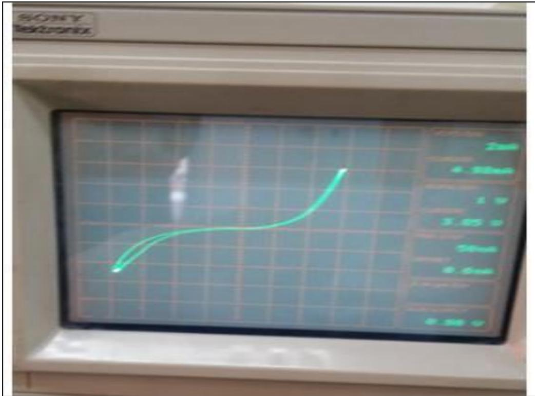
**Figure IV.11** : Caractéristique I-V visualisée sur le traceur de courbes.
