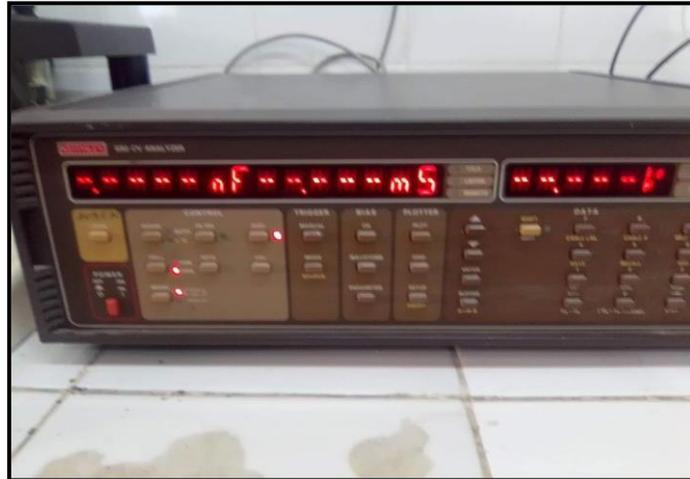
**Figure II.21** : C(V)-mètre utilisé dans ce travail.
