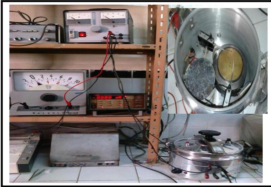
**Figure. II. 18 :** Montage électrique utilisé pour la mesure I(V) des couches minces.
