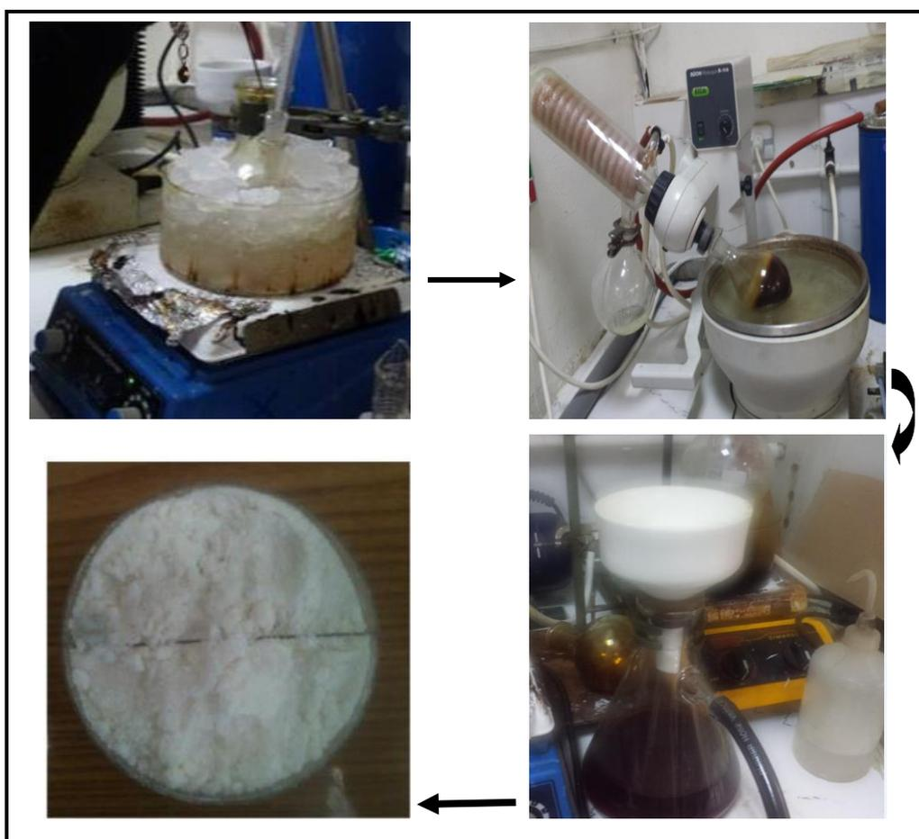
**Figure II.6.** Différentes étapes de la préparation chimique du sel d'iodure de méthylammonium ( $\text{CH}_3\text{NH}_3\text{I}$ ).
