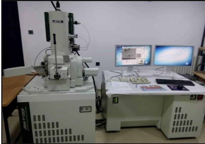
**Figure II.13:** Photographie du microscope électronique à balayage (Horiba scientific JSM-7100) utilisé.
