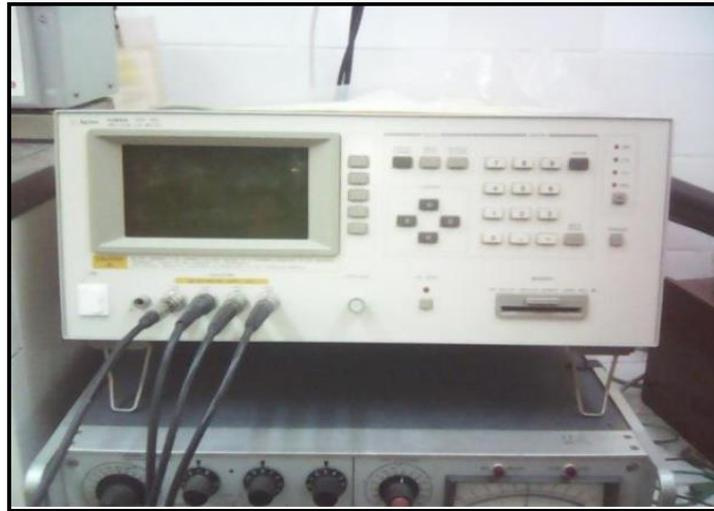
**Figure. II.22.** Impédance mètre utilisé pour la mesure C-G-f
