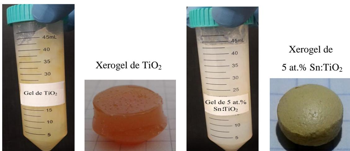
**Figure IV.1** : Photos des gels et des xérogels de  $\text{TiO}_2$  et 5 at.% Sn: $\text{TiO}_2$ .
