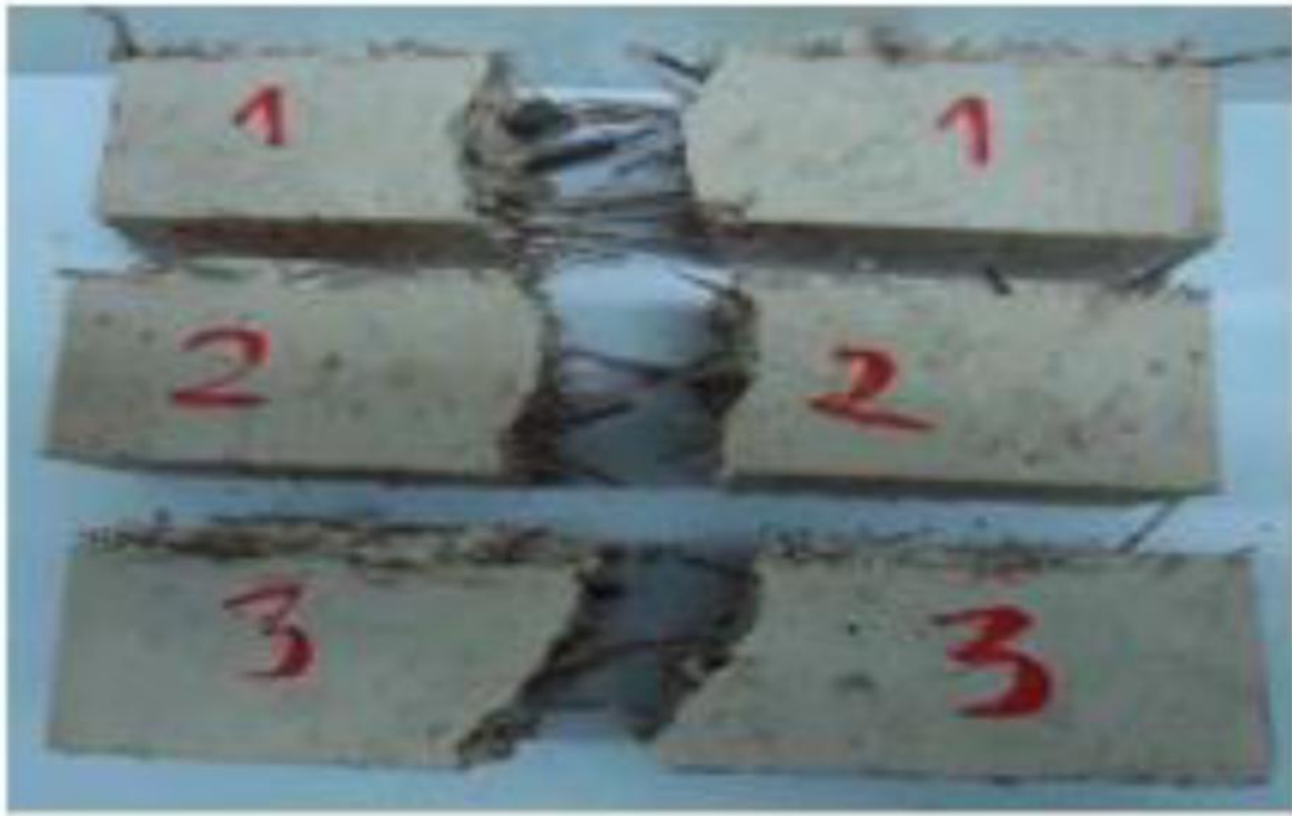
Figure 1.15 : Echantillons de composite gypse-fibres après des essais de flexion [32].
