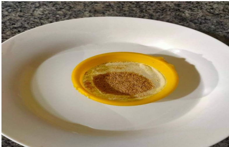
Figure 3.8 : Dispositif de saturation des fibres de bois de palmier dattier FDP.
