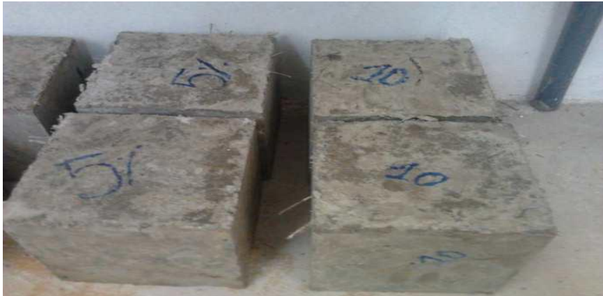
Figure 1.18 : Echantillons de composite fibres-matrice à base de ciment [21].
