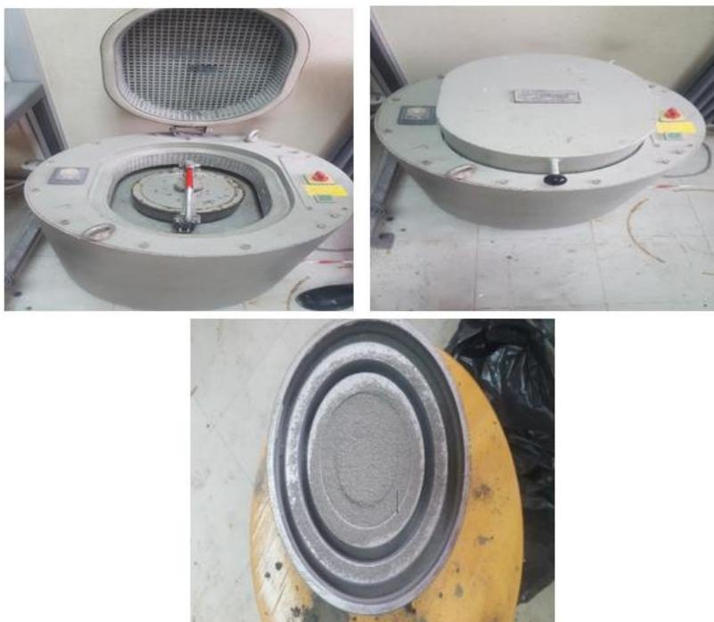
**Figure IV-4.** Broyeur grand format (atelier des lames minces, département des sciences géologiques).
