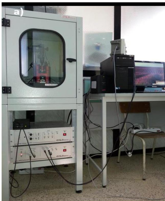
**Figure II.13.** Photographie du microscope à force atomique de type A.P.E. Research-A100 de l'université d'Oum El Bouaghi.
