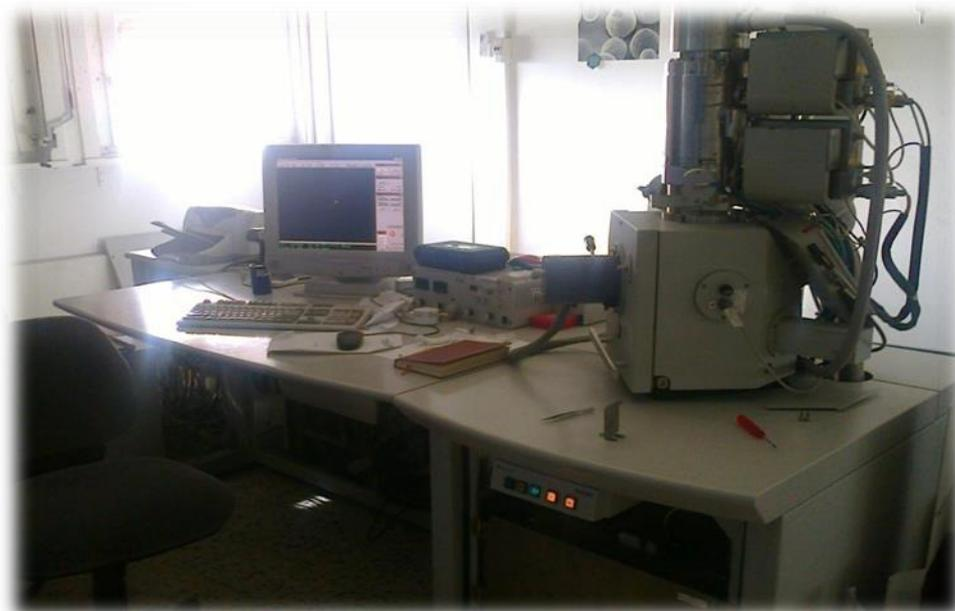
*Figure II.11. Microscope électronique à balayage de type ESEM XL 30 FEG Philips.*
