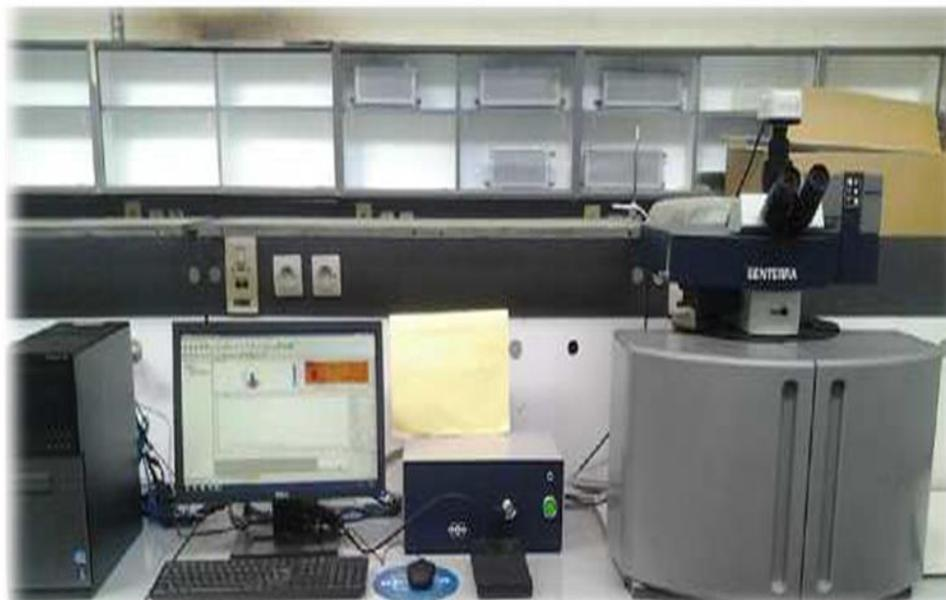
**Figure II.10.** Spectromètre  $\mu$ -Raman du laboratoire de cristallographie de l'université Frères Mentouri- Constantine 1.
