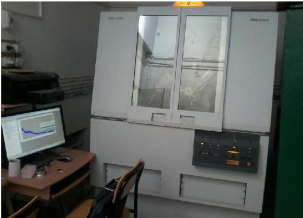
*Figure II.8. Photo du Diffractomètre X'PertPro de Panlytical du Laboratoire de Cristallographie de Université des Frères Mentouri Constantine 1.*
